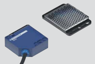
Reflexionslichtschanke Extra 627 • Geeignet für 24-240 V AC, 12-240 V DC, IP 54 • Reichweite 5 m
